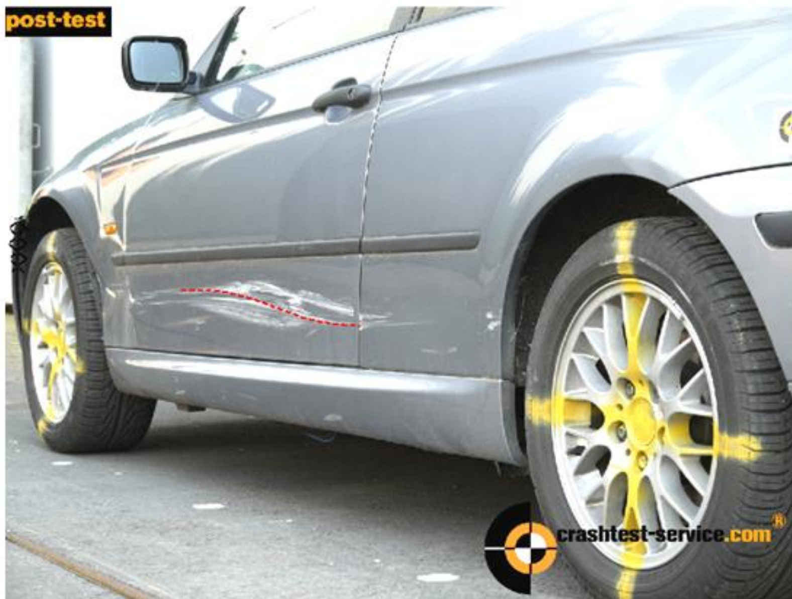
Obr. č. 14: Uspořádání stop na boku vozidla BMW, nárazová zkouška č. 2
