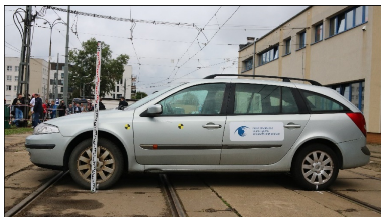
Obr. 2 - Vůz Renault Laguna použitý při crash testu. Fig. 2 – The Renault Laguna car used in a crash test.
