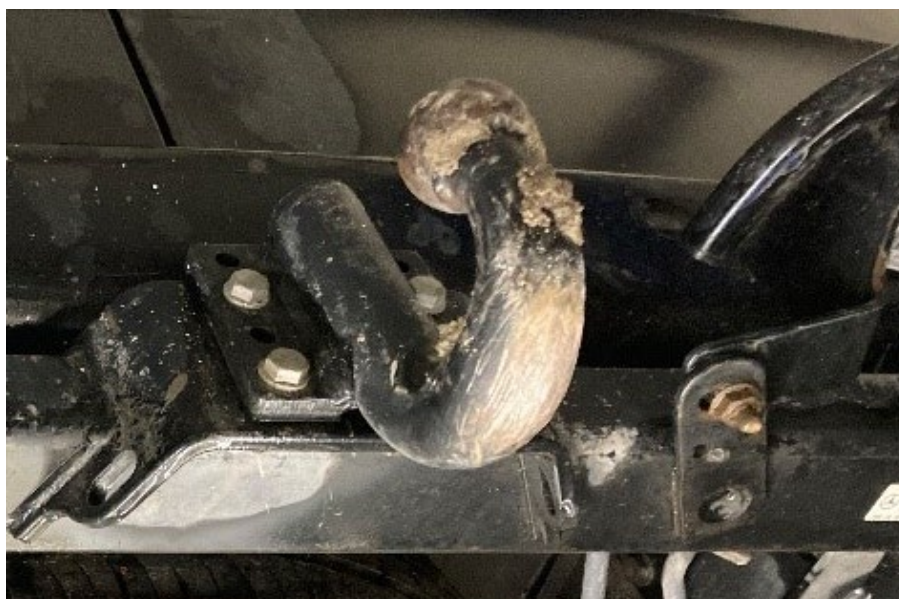
Obr. 23 – Pohled na tažné zařízení při úvodním ohledání po porušení Fig. 23 – View on the Towbar During the Initial Inspection after the Breach
