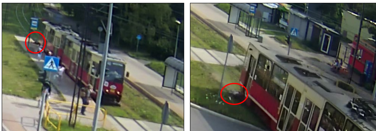
Obr. 7 - Snímky videa. Vlevo - zavírání dveří tramvaje - cestující padá na nástupiště, vpravo - zastavení tramvaje - cestující je vlečena tramvaj.
