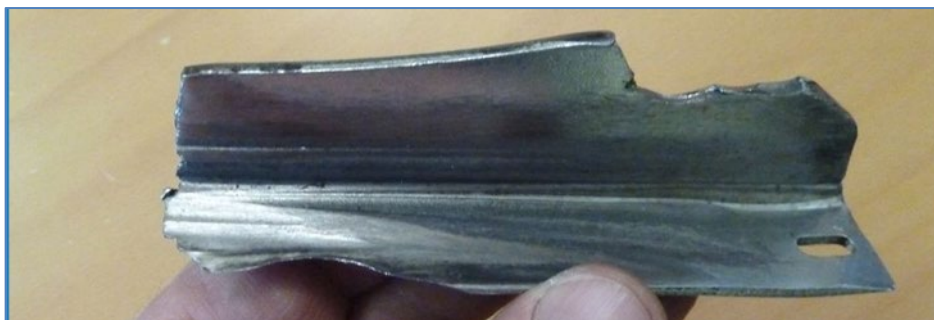
Obr. 6 - Detailní zobrazení poškození a opotřebení části vodící lišty
