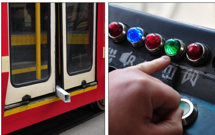
Obr. 5 – Klocek o szerokości 40 mm włożony pomiędzy drzwi tramwaju i kontrolka sygnalizująca zamknięcie drzwi.
