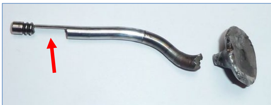
Obr. 10 - Pohled na poškozený ventil, kde je viditelná oblast provádění zkoušek materiálové struktury
