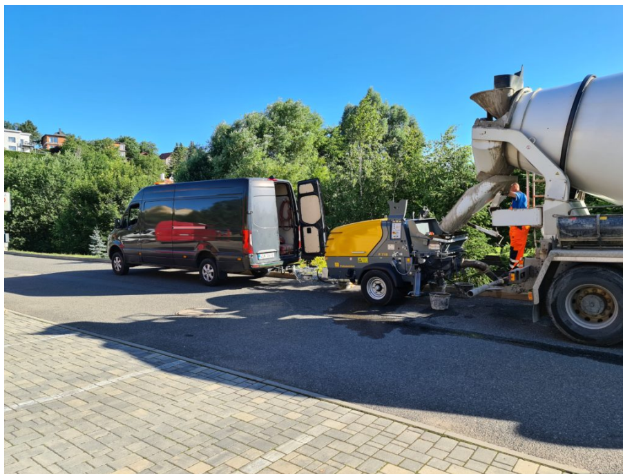
Obr. 24 – Způsob použití čerpadla betonu u uživatele Fig. 24 – Usage of the Liquid Concrete Pump at the User's Site
