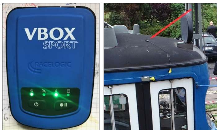
Obr. 5 - VBox Sport (vlevo) a letecký pohled na zařízení na střeše tramvaje (vpravo). Fig. 5 – VBox Sport (left) and a view of the device's antenna on the roof of the tram (right).
