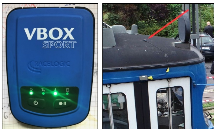
Obr. 5 – VBox Sport (po lewej) i widok anteny urządzenia na dachu tramwaju (po prawej). Fig. 5 – VBox Sport (left) and a view of the device's antenna on the roof of the tram (right).
