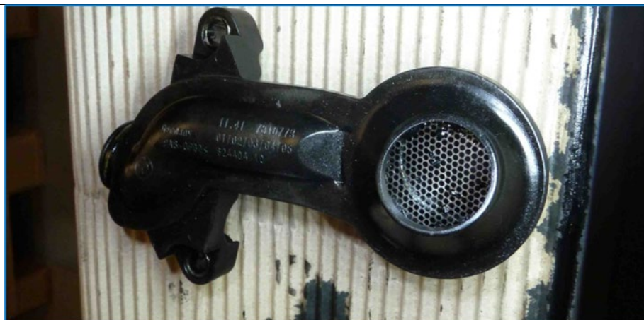
Obr. 17 – Pohled na sací koš Fig. 17 - View of the suction basket
