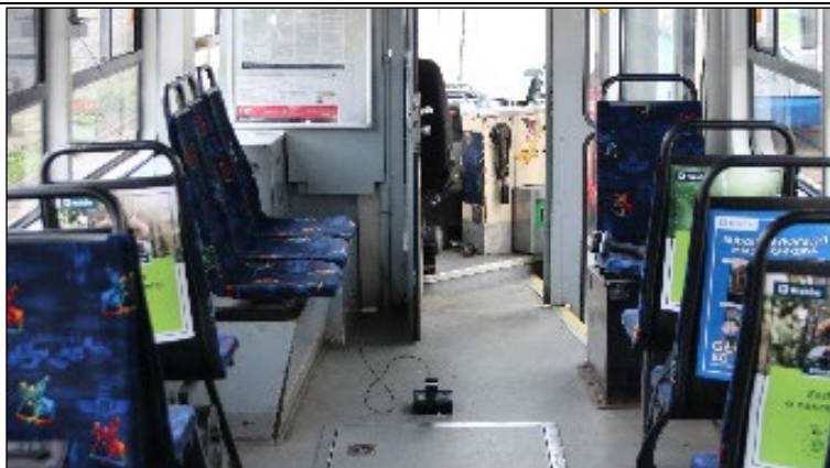
Obr. 4 - Pohled na měřicí plošinu PicDAQ5 připevněnou k podlaze tramvaje. Fig. 4 – View of the PicDAQ5 measurement platform attached to the floor in the tram.
