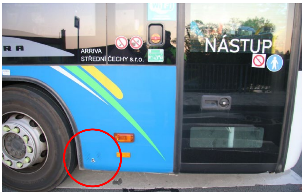
Obr. 4. Fotografie stopy kontaktu předního kola z jízdního kola cyklistky X.Y. s Arrivou. Fig. 4. Photo of the contact mark of the front wheel from the bicycle of cyclist X.Y. with Arriva.
