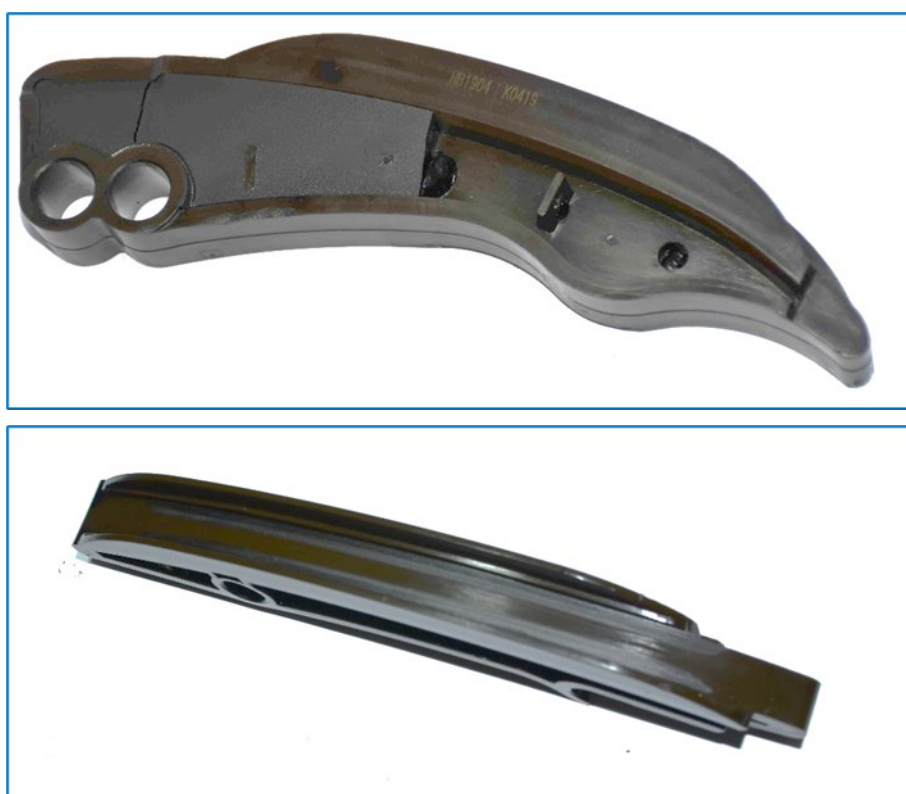
Obr. 20 – Stav a poškození vodící lišty Fig. 20 - Guide rail condition and damage
