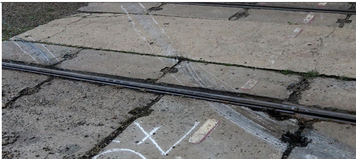
Obr. 17 – Prążki widoczne na śladzie od opony. Fig. 17 – Stripes of the tire visible on the track.
