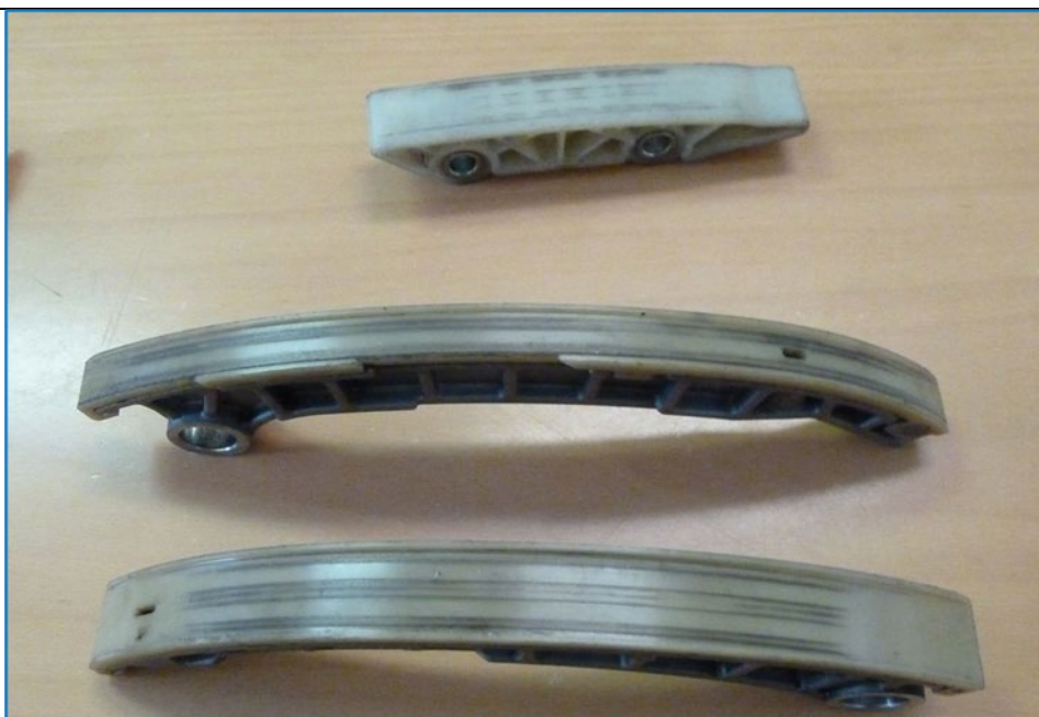
Obr. 7 - Zobrazení opotřebení a poškození vodících lišt
