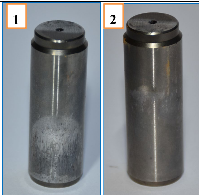
Obr. 21 – Otláčení na obvodu pístu Fig. 21 - Pressure on the circumference of the piston
