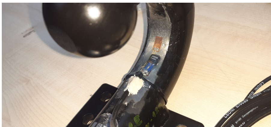
Obr. 9 - Pohled na nainstalovaný tenzometrický systém
