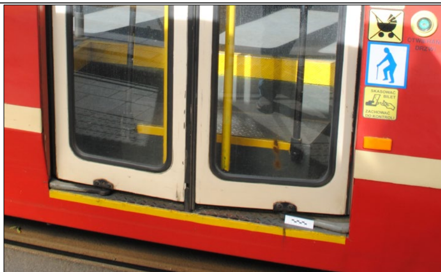
Obr. 2 - Nedovírající se dveře vozu.
