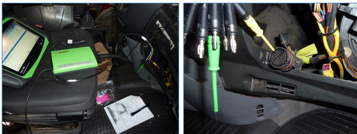
Obr. 2 – Diagnostika elektronické řídicí jednotky motoru Fig. 2 - Diagnostics of the electronic engine control unit
