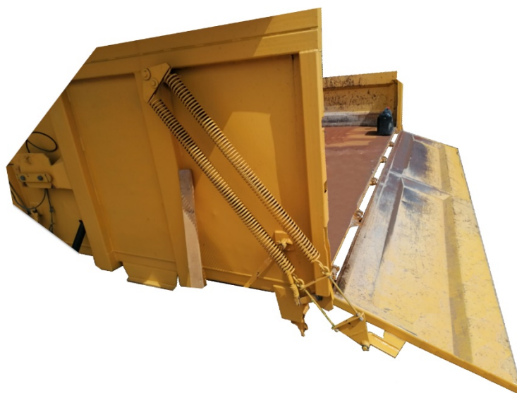
Obr. 1 – Korba nákladního vozidla s pružinovým mechanismem, otevřená bočnice Fig. 1 - Tipper body with spring mechanism, opened sidewall
