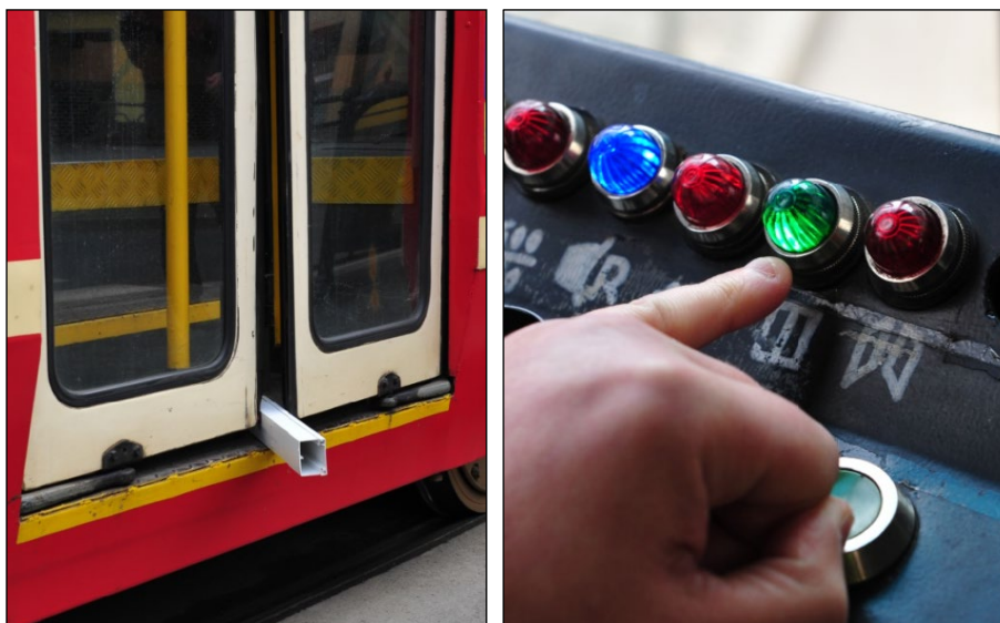
Obr. 5 - 40 mm široký kvádr vložený mezi dveře tramvaje a světelnou signalizaci, že jsou dveře zavřené. Fig. 5 – A 40 mm wide block inserted between the tram doors and a light signaling that the door is closed.
