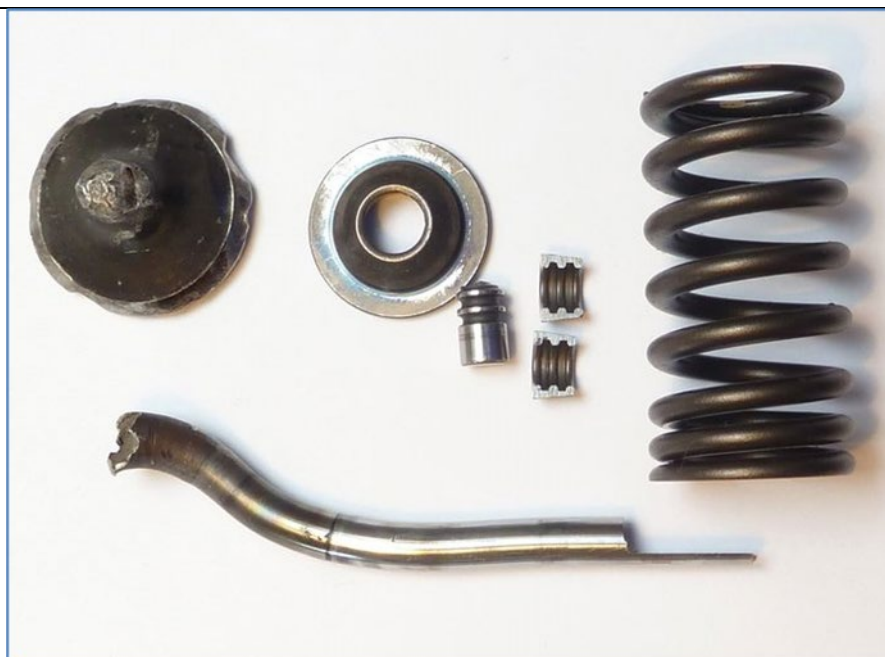
Obr. 9 - Poškozený ventil a další dodané díly Fig. 9 - Damaged valve and other parts supplied
