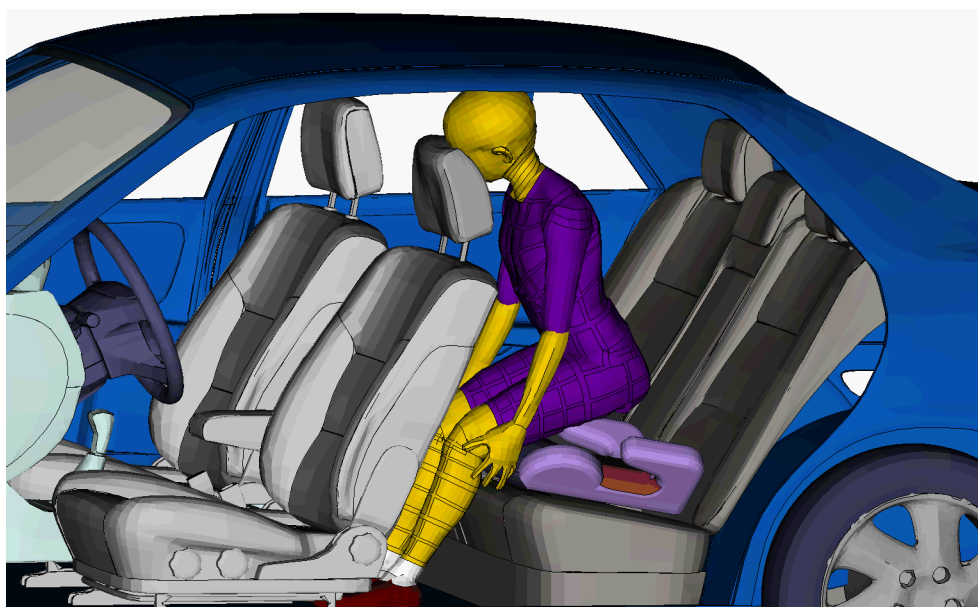
Obr. 29 – Kontakt hlavy chlapce a hlavovou opěrkou řidiče, varianta 3B, rychlost 36 km/h, čas cca 120 ms, boční pohled Fig. 29 – Contact of the boy's head and the driver's headrest, variant 3B, speed 36 kph, time approx. 120 ms
