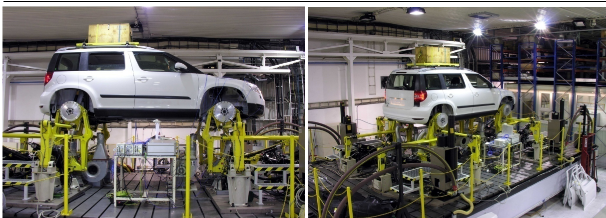
Obr. 45 a 46 – Pohled na 16 kanálový simulátor vozovky série 329 (MTS)
