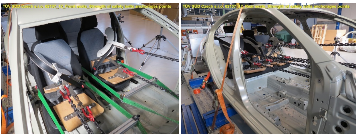
Obr. 5 a 6 – Uspořádání zkoušky úchytů předních a zadních bezp. pasů Fig. 5 and 6 – Front and rear seat belts fittings test arrangement
