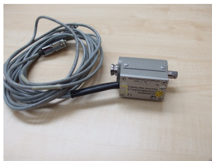
Obr. 28 – Pohled na snímač momentu a úhlu natočení Fig. 28 – Torque and rotation angle sensor view
