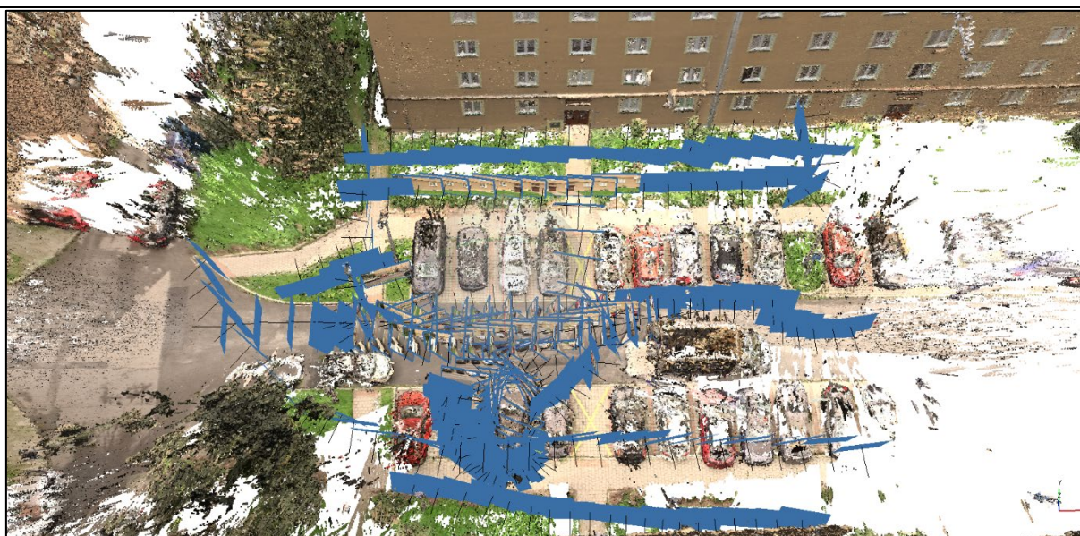
Obr. 3 –Pozice snímků při fotogrammetrickém modelování Fig. 3 – Camera positions from photogrammetry modelling
