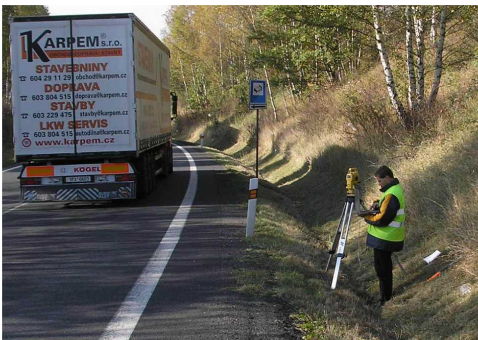
Obrázek č. 7 – Data z Total-Station lze přenášet přímo do notebooku na měřeném místě
