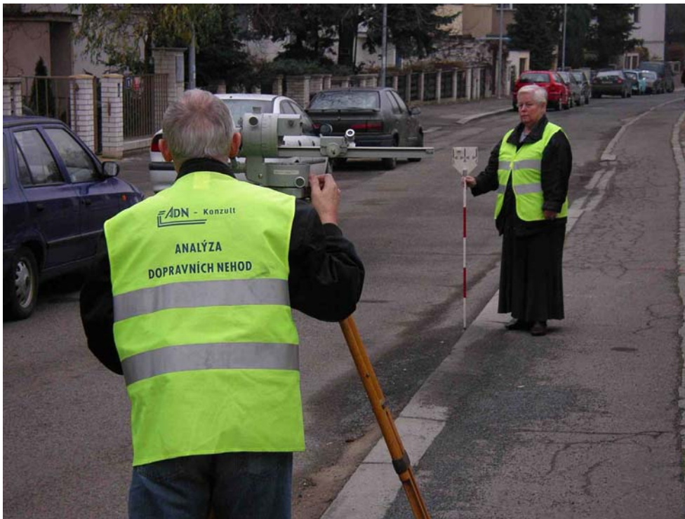
Obrázek č. 5 – Autoredukční tachymetrický přístroj ZEISS BRT 006
