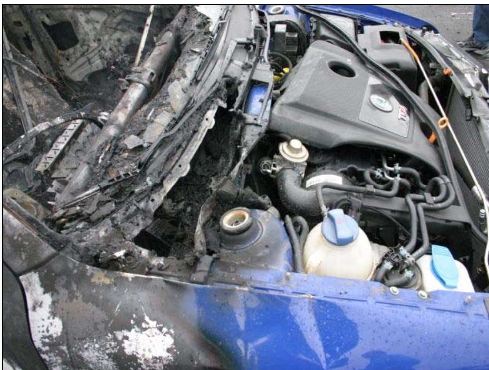
Obrázek 37 - Stav prostupujícího ohně do motorového prostoru, a to v montážním místě jednotky topení a větrání.
