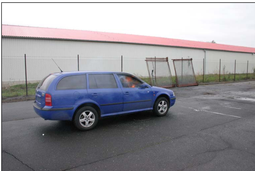
Obrázek 19 - Po době 3 minut hoření došlo k výraznému útlumu plamene s projevem občasného vyšlehnutí plamene z otvoru okna a to zejména následkem hoření obvodového těsnění a výplně dveří.
