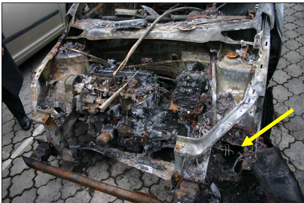
Obrázek 40 - Požárem poškozený motorový prostor ve stavu po šetření Policií. Šipka ukazuje do montážního prostoru hydraulické jednotky ABS, která byla z vozidla vyjmutá technikem Policie.
