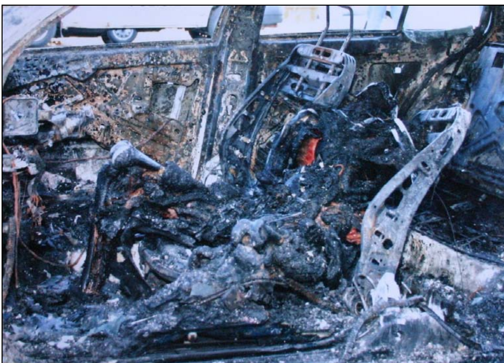
Obrázek 2 - Torzo shořelého řidiče ve vozidle. Zjištěná deformace opěradel předních sedadel.
