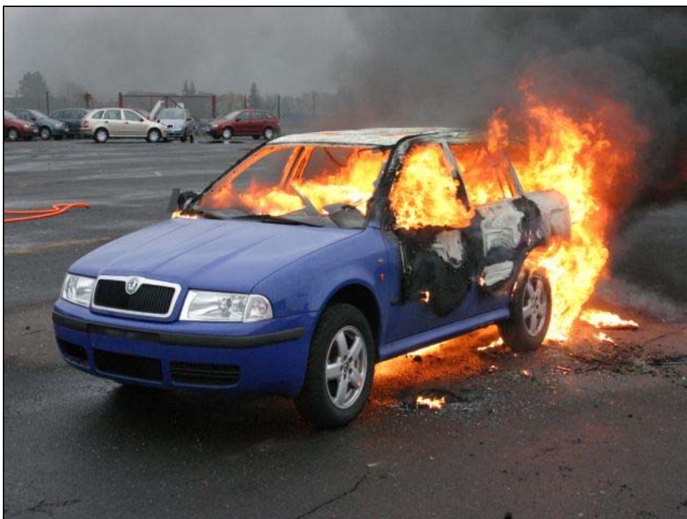
Obrázek 32 - V době 11 minut od zapálení se zjišťuje počátek hoření pneu levého zadního kola. Značná intenzita hoření se zjišťuje pod vozidlem zejména v místě za zadní nápravou.
