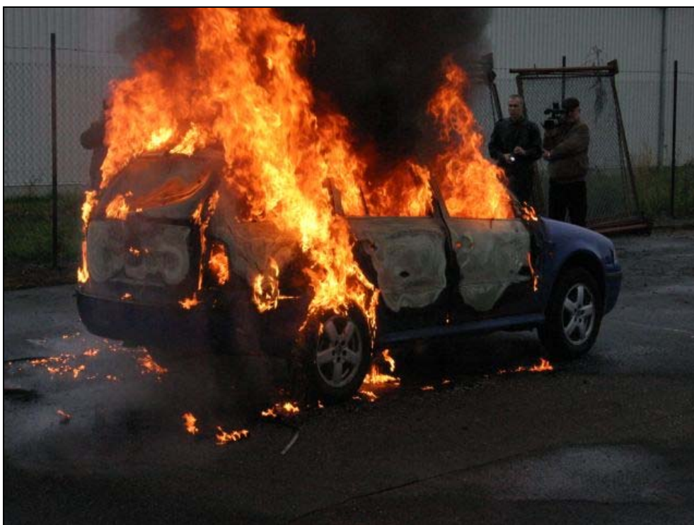
Obrázek 29 - Čas 8:10 minut od zapálení, kdy se zjišťuje počátek hoření pravé zadní pneu, která je dosud stále nahuštěná. Sklo zadních výklopných dveří je stále celistvé. Zjišťuje se oddělení krytů koncových svítilen, které dohořívají spolu s oddělenými plastovými díly na zemi.
