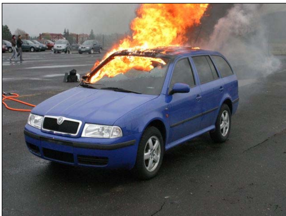
Obrázek 24 - Stav rozšíření požáru po 2:50 minut po jeho iniciaci. V daném čase se zvětšil otvor v čelním skle a nastala destrukce stropního okna.
