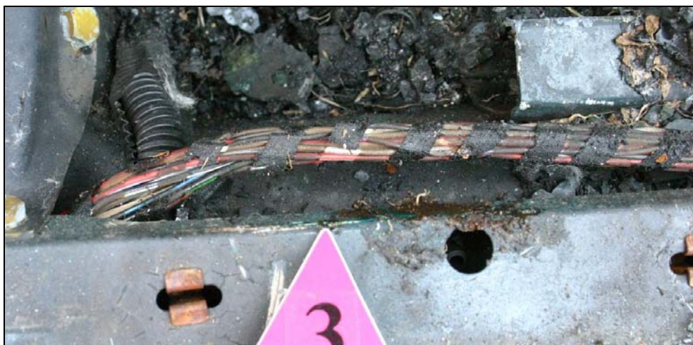
Obrázek 7 - Požárem nepoškozený svazek vodičů uložený u levého prahového nosníku.
