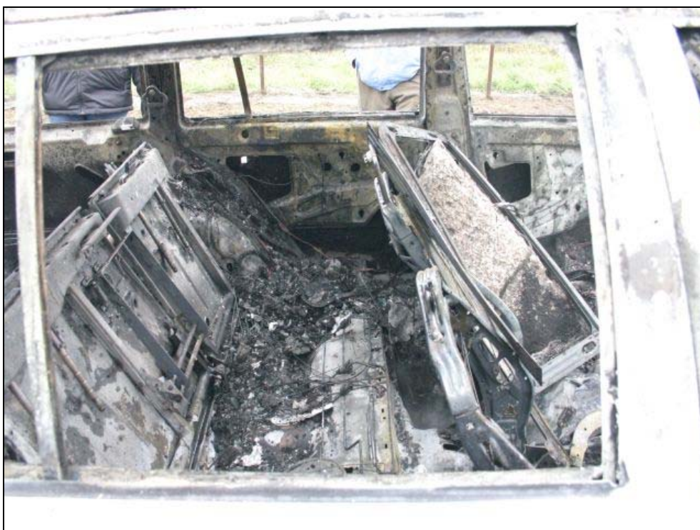
Obrázek 35 - Po požáru se nezjišťuje vznik deformace opěradla řidiče jako následek působení statické síly vyvolané hmotností kamenného kvádrů. V daném případě se dovozuje, že vznik deformace obou opěradel vznikla již před požárem automobilu v místě jeho požáru.
