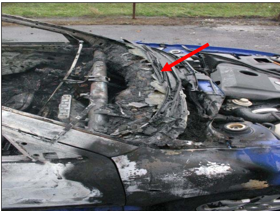
Obrázek 36 - Z hlediska působení teploty z hoření je zjištěné nepoškození pryžové stěrací lišty levého stěrače stavem vysvětlující proudění vzduchu do míst hoření.
