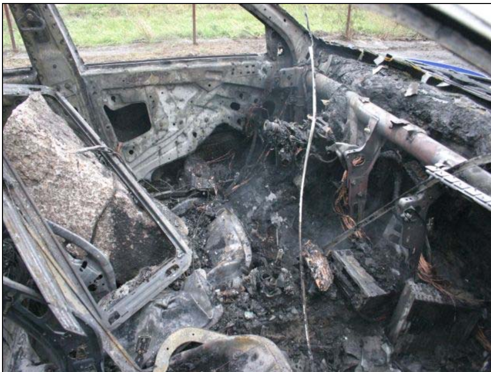
Obrázek 38 - Pohled na přístrojovou desku automobilu, kde se nezjišťuje poškození tělesa zámku řízení jeho roztavením jak bylo zjištěno v případě požáru zkoumaného automobilu.
