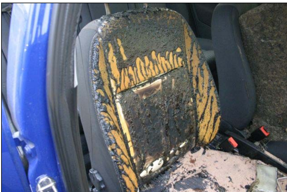
Obrázek 21 - Požárem poškozený látkový potah opěradla sedáku spolujezdce zasahující molitanovou výplň.
