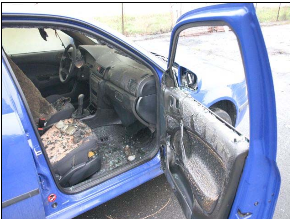
Obrázek 17 - Po 8:40 min došlo k výraznému utlumení požáru směřující k jeho úplnému samouhašení. Požárem je poškozená část přístrojové desky před sedákem spolujezdce, výplň pravých předních dveří a látka sedáku včetně opěradla spolujezdce. Požárem je také poškozený stropní panel, ze kterého visí taveniny plastu.
