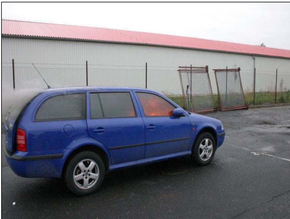
Obrázek 16 - Stav hoření uvnitř automobilu – pootevřené zadní výklopné dveře.
