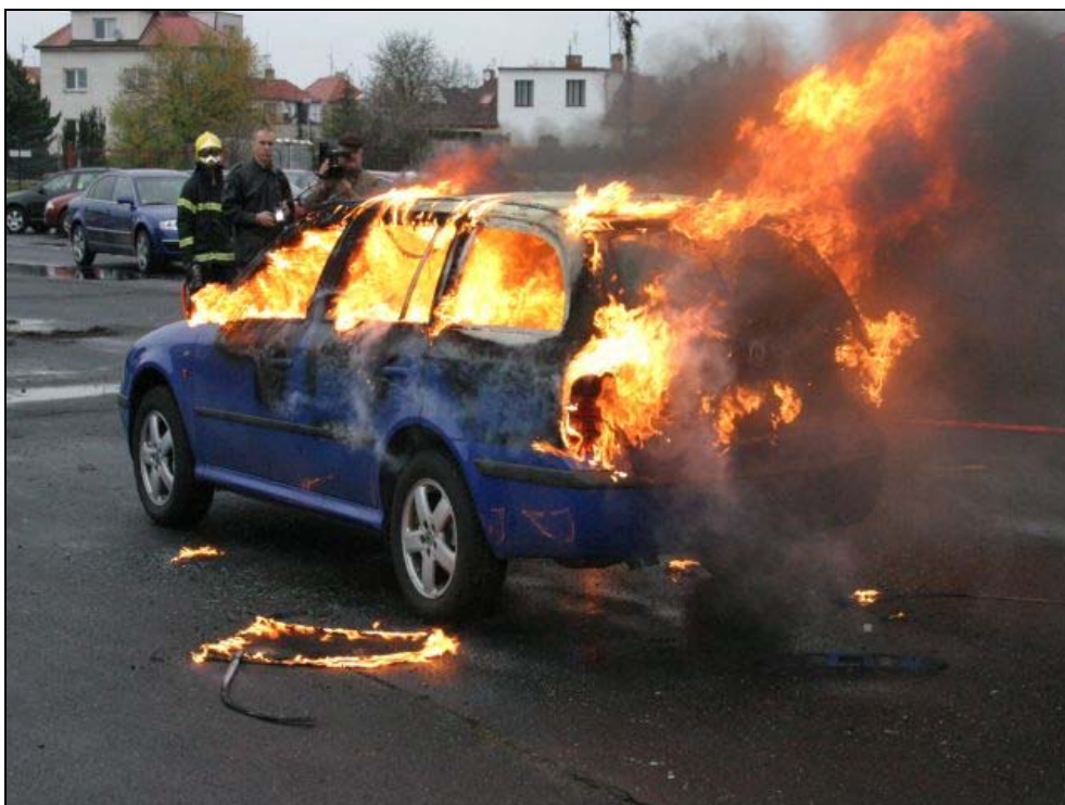
Obrázek 28 - Stav hoření ve stejné době 6 minut po zapálení kdy došlo k oddělení (vypadnutí) bočního okna „D“ sloupku karosérie. Dále se zjišťuje hoření v místech koncových svítilen tak i kolem výklopných dveří.
