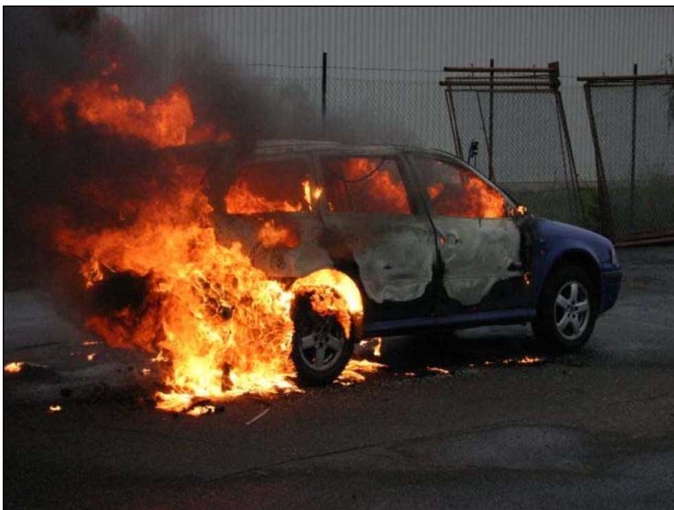
Obrázek 30 - V době 9:40 minut od zapálení dochází k hoření vytékajícího paliva z nádrže a k destrukci skla zadních výklopných dveří. Pneu pravého zadního kola je dosud stále nahuštěná. V přední části čelního skla se výrazně snížila intenzita hoření.
