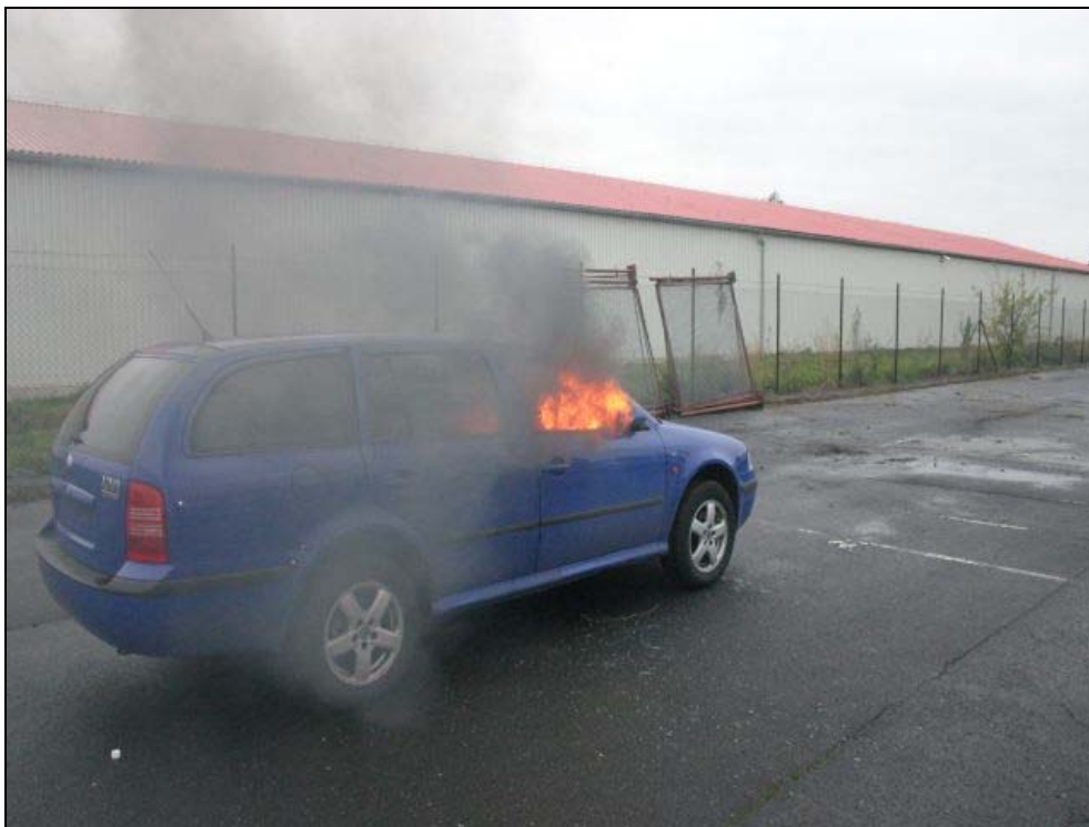
Obrázek 18 - Hoření uvnitř automobilu za současného uzavření všech dveří.
