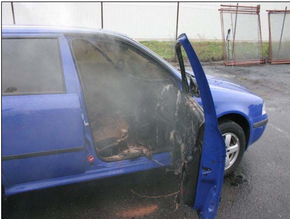
Obrázek 20 - Po uplynutí cca 8 minut došlo k uhašení požáru. Zjišťuje se úplná destrukce výplně dveří, přístrojové desky před sedákem spolujezdce a pravé poloviny střešního panelu. Částečné ohoření se zjišťuje na přilehlé straně sedáku a opěradla řidiče tak i v místě středového panelu u řadící páky. Čelní sklo je dosud celistvé se znaky bílých oválných skvrn.
