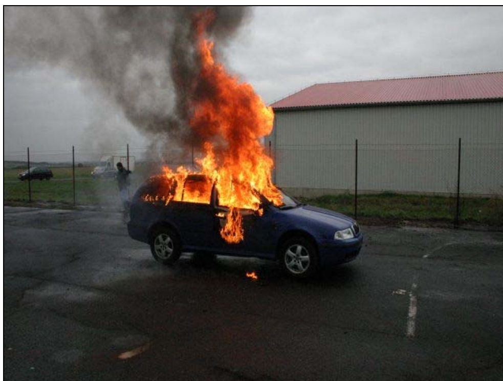
Obrázek 25 - Stav hoření po 3:15 minut po zapálení. V tomto čase nastala destrukce okna pravých zadních dveří.
