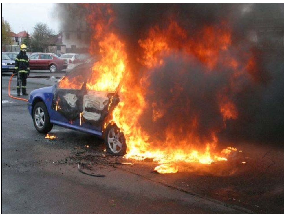
Obrázek 33 - V době 13 minut od zapálení dochází k explozi pneu levého zadního kola vyznačující se zvukově s okamžitým nárůstem intenzity hoření a to vlivem tzv. vzduchové injekce.
