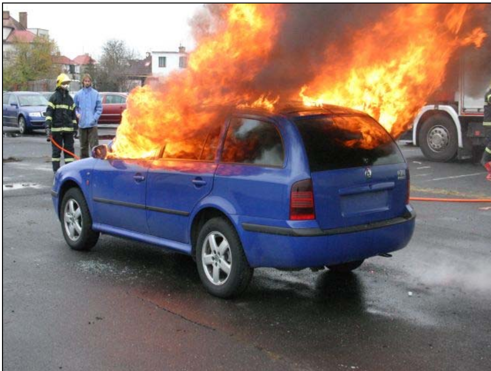
Obrázek 26 - Stav hoření po 4 minutách od zapálení. V této době hoření došlo u automobilu k destrukci okna levých předních dveří.
