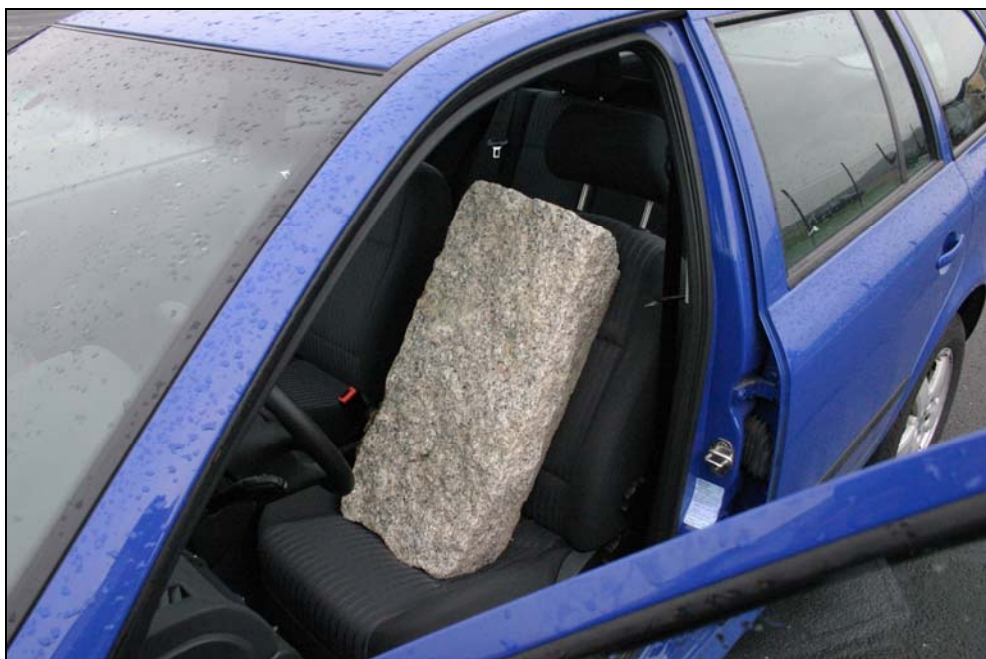
Obrázek 11 - Kamenný kvádr o hmotnosti 80 kg imitující sedícího řidiče. Úkolem bylo ověřením možné deformace opěradla vzniklým požárem.
