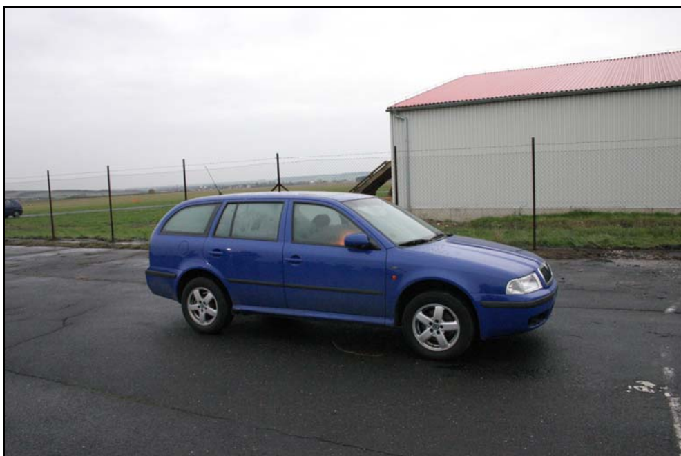
Obrázek 14 - Stav hoření po době cca 1 minuty. Po uplynutí cca 4 min. došlo k samouhašení požáru vlivem nedostatku kyslíku ve vnitřním prostoru automobilu.
