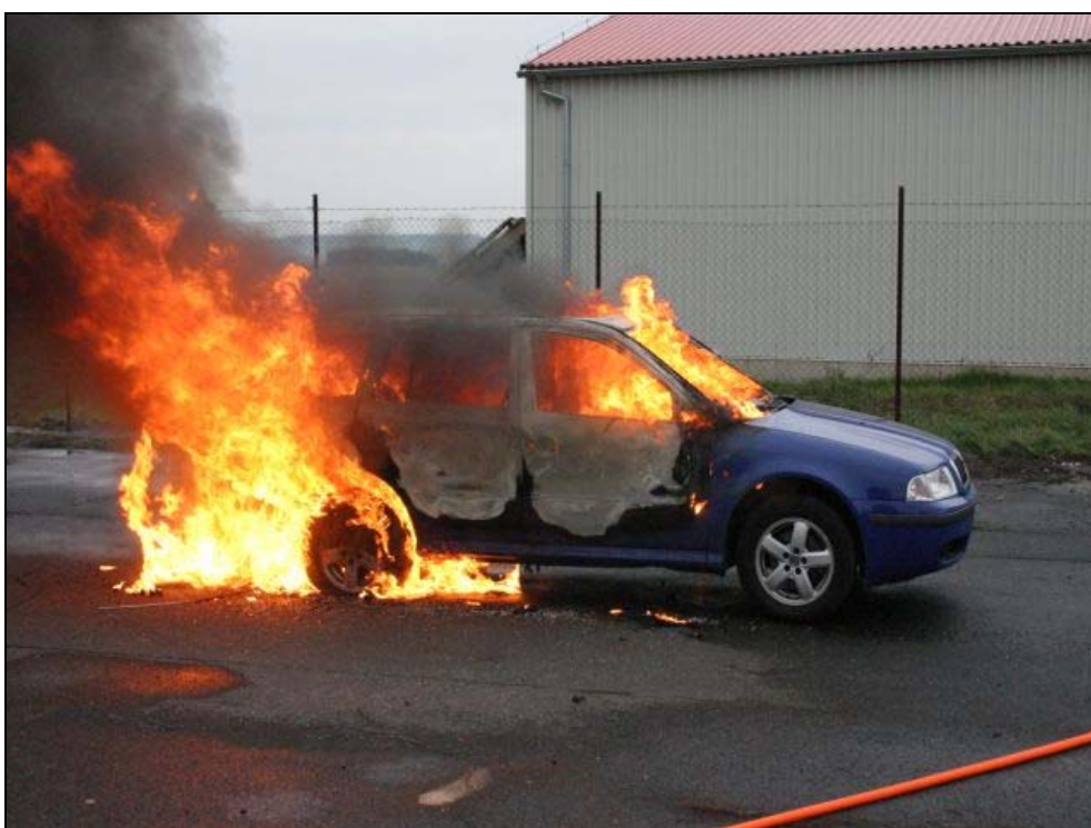
Obrázek 31 - V době 10:30 minut od zapálení dochází k explozi pneu pravého zadního kola vyznačující se zvukově s okamžitým nárůstem intenzity hoření. V místě přístrojové desky se zvýšila intenzita hoření.
