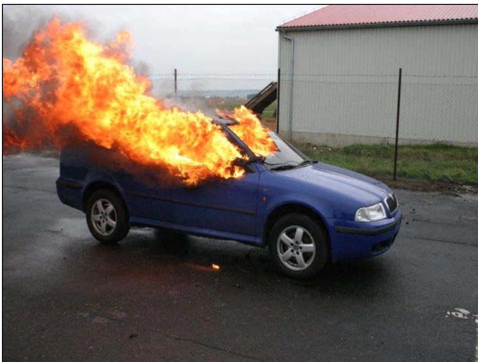
Obrázek 23 - V době po 1:40 minut od zapálení došlo k destrukci čelního skla, střešní sklo a skla ostatních dveří byly nadále celistvé.
