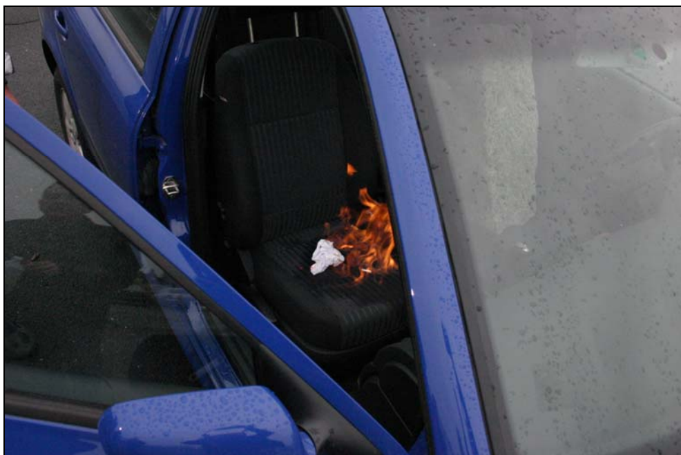
Obrázek 13 - Vznik zahoření v místě sedáku spolujezdce po aplikaci ½ litru lihu. Čas založení požáru 11:45:34 hod.
