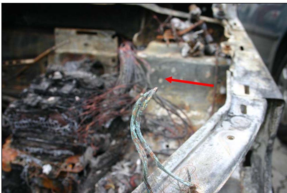
Obrázek 41 - Zkratem „svažené“ vodiče napájení hydraulických ventilů a motorku čerpadla jednotky ABS, které jsou jištěné pojistkou 2 x 30 A.
