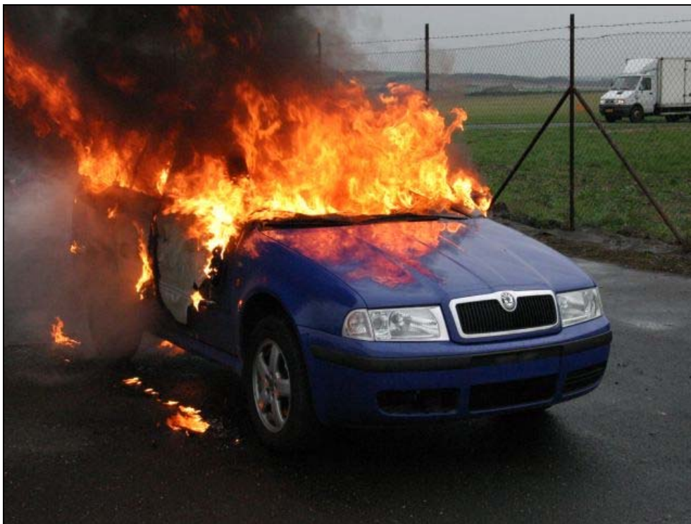
Obrázek 27 - Stav hoření po 6 minutách od zapálení. V této době hoření došlo k destrukci zasklení bočních dveří u automobilu.
