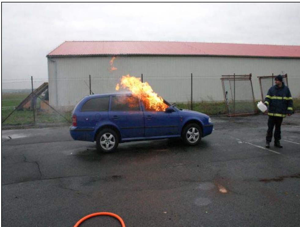
Obrázek 22 - Intenzita požáru po aplikaci 5 litrů benzinu, které po zapálení předcházela okamžitá detonace dosahující vyšlehnutí plamene do strany v délce cca 3 metrů za současného otevření levých předních dveří, které před zážehem byly pootevřené.
