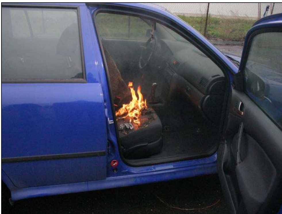
Obrázek 15 - Stav opětovného rozhoření po otevření dveří. Provedeno následné uhašení požáru.
