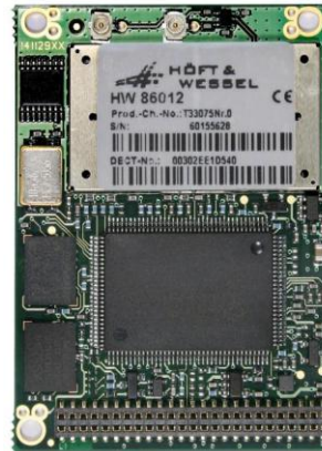
Obrázek č. 2 – Modemy pro bezdrátový přenos dat – vlevo AeroComm AC4868-250, vpravo Höft&Wessel HW86012.
