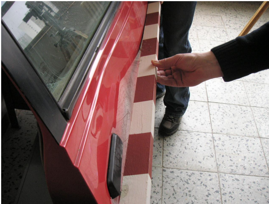
Obr. 3 - Pohled na deformaci dveří po skončení všech silových zkoušek
