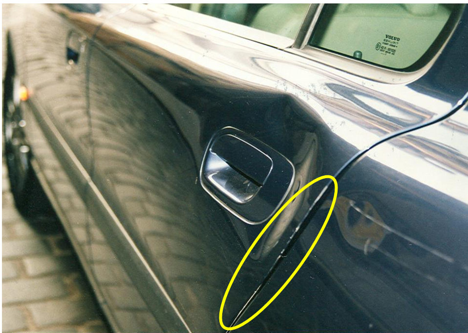
Obr. 5 - Označení poškození hrany dveří
