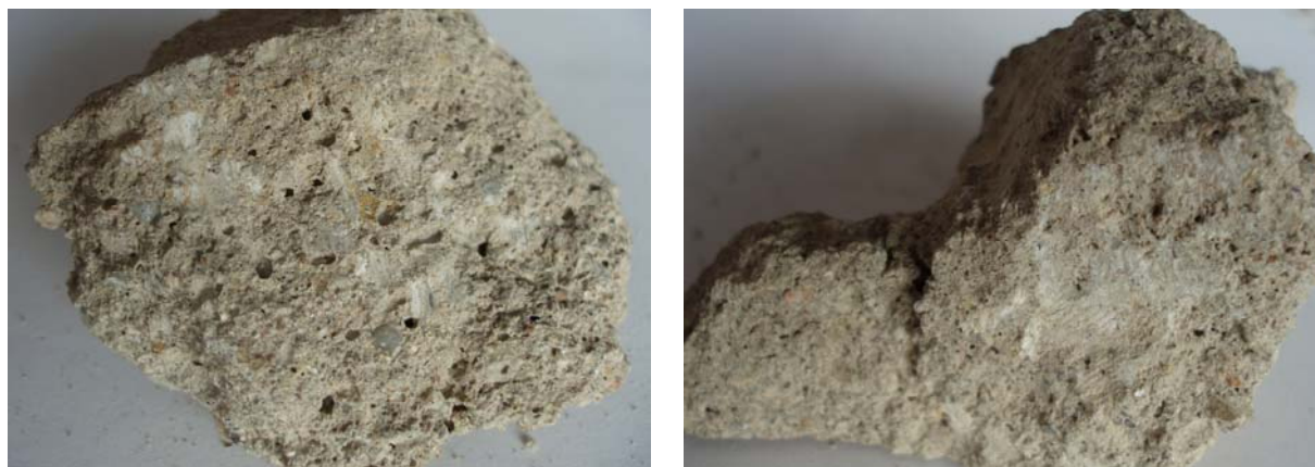
Foto č. 8, 9 Vzorky betonové mazaniny odebrané ze sond
