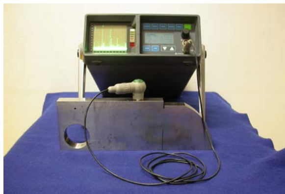
Obr. 1 Nastavení rozsahu UZ přístroje na 400 mm na měrce K-1
