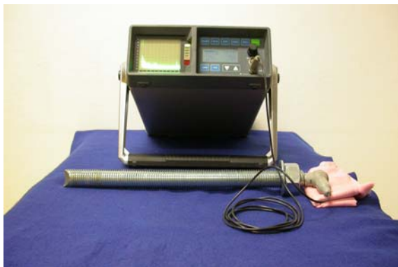
Obr. 2 Zkalibrování UZ přístroje na délku kotevního šroubu
