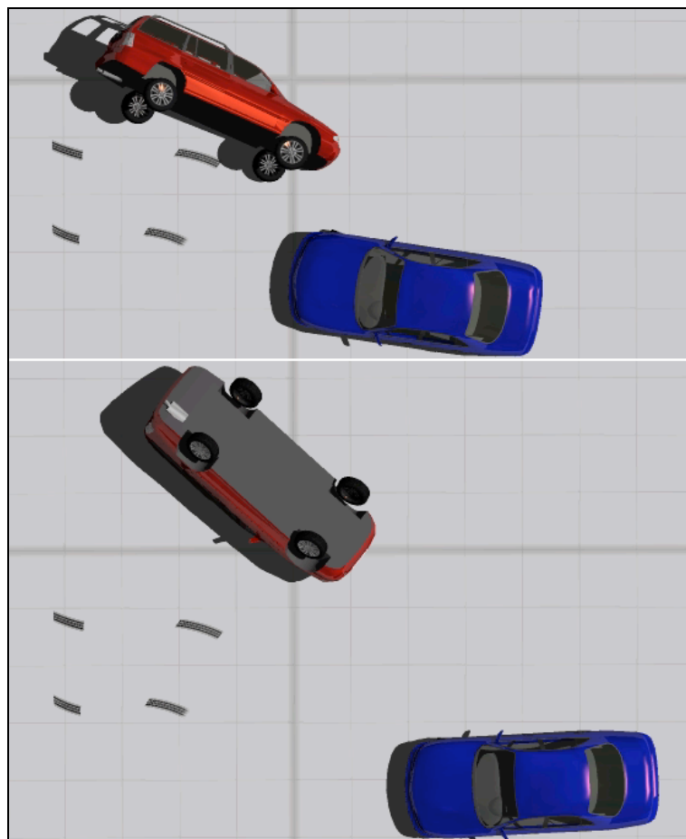
Obr. 19 – Pohled shora na postřetový pohyb vozidel Fig. 19 – Course of the motion post impact from the top view
