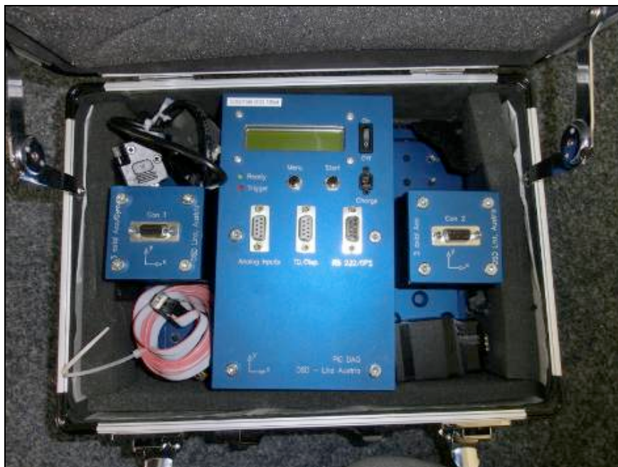
Obr. 3 – Zařízení pro sběr dat - PicDAQ Fig. 3 – Measurement devices - PicDAQ
