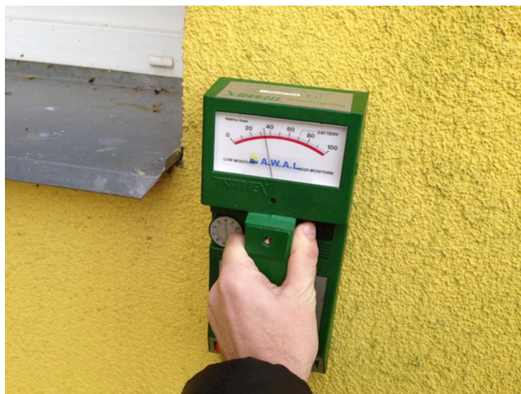
Obr. 1 – Přístroj k měření vlhkosti pomocí ID. Fig. 1 – Appliance for humidity detection by ID.
