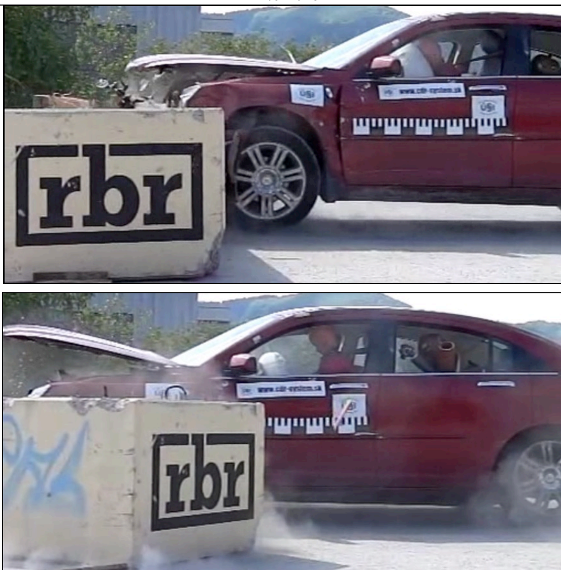
Obr. 1 – Sekvencia nárazu vozidla do bariéry
